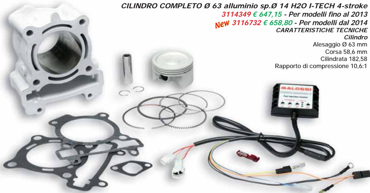
Materiale: lega primaria di alluminio ad alto tenore di silicio bonificato, canna con riporto di carburi di silicio in una matrice di nichel galvanico e levigatura incrociata con due passaggi di diamanti con tolleranze ristrettissime
